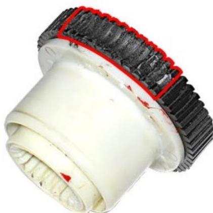
**SOLUTION** Remplacement de l'engrenage de l'actionneur de boîte de transfert.
