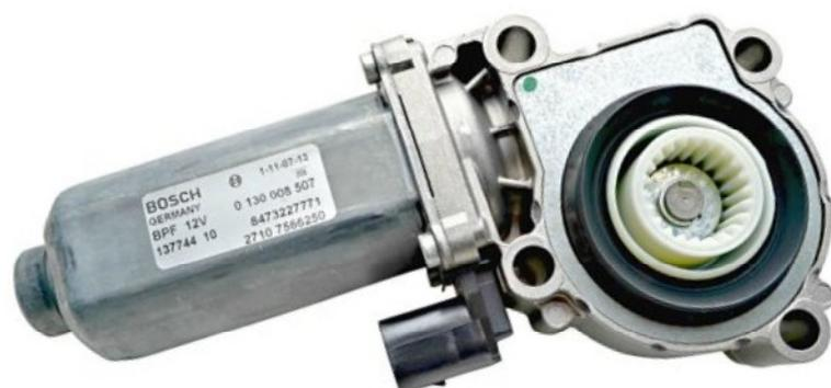
Ce problème provient d'un engrenage abîmé à l'intérieur de l'actionneur de boîte de transfert. Ce pignon à l'origine en nylon peut être remplacé indépendamment de l'actionneur complet par un pignon fabriqué en plastique/fibre de carbone plus résistant.
